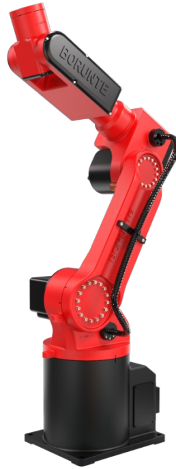
Borunte BRTIRUS0805A – kompakt 6 tengelyes robot, 30–250 T fröccsöntő gépekhez
